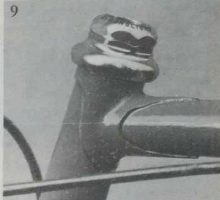
Mise en place de la cuvette supérieure et du blocage.
