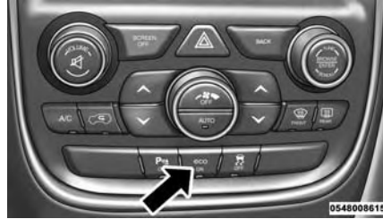
مفتاح وضع ترشيد استهلاك الوقود
