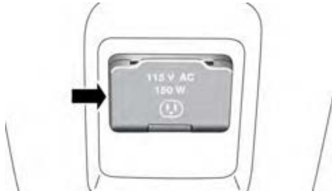
115 Volt Power Inverter
