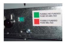
Señalización de fusible fundido o en funcionamiento, mediante color rojo o verde.
