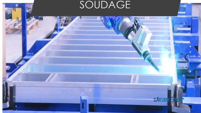
Suite à leur découpe chacun des profils est placé automatiquement sur un gabarit garantissant ainsi de façon précise la parfaite mise en place pour la soudure. Démarre ensuite l'étape primordiale dans la fabrication des panneaux, la soudure, élément de sécurité à part entière. Afin d'assurer une qualité irréprochable, chaque soudure est effectuée de manière robotisée .
