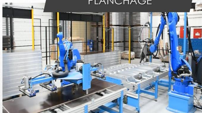
Afin d'éviter la pénétration de l'eau dans les fibres du contreplaqué, et pour améliorer la qualité visuelle du panneau, un joint est appliqué par bras robotisé en amont de la phase de planchage, cela évite le phénomène de rippling.
