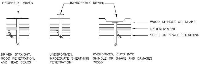
GOOD PENETRATION, AND HEAD BEARS FIRMLY AGAINST THE SHINGLE OR SHAKE SURFACE
