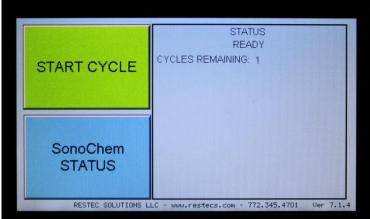
ON THE RUN SCREEN, THE SYSTEM SHOWS CYCLES REMAINING AND WILL PROMPT THE OPERATOR WHEN RELOADING IS REQUIRED
