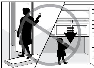
Mantenga la puerta a la vista hasta que se cierre por completo cuando utilice el botón pulsador o transmisor montado en la pared.
