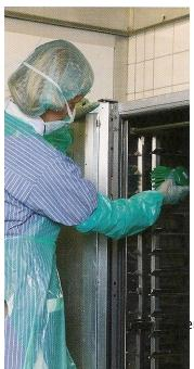
Certaines pièces doivent être démontées pour les nettoyer efficacement. De plus, il convient d'utiliser des outils de forme spéciale. De tels outils de nettoyage protègent les mains et les doigts tout en garantissant que toutes les saletés disparaissent rapidement des zones les plus difficiles à atteindre. Ces outils sont fabriqués à partir de matériaux les rendant faciles à nettoyer et à conserver.
