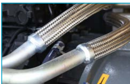
Manguera de trenzado metálico que mejora la seguridad y longevidad.
