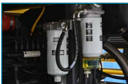
Filtro de combustible adicional de serie para garantizar la protección del motor.
