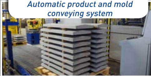
Encaminhamento automático dos produtos e dos moldes
