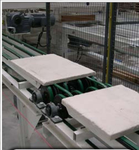
Encaminhamento automático dos produtos e dos moldes
