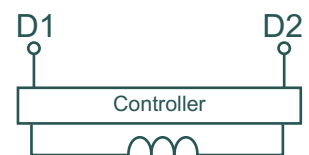
Denominación terminales de la bobina de mínima tensión
