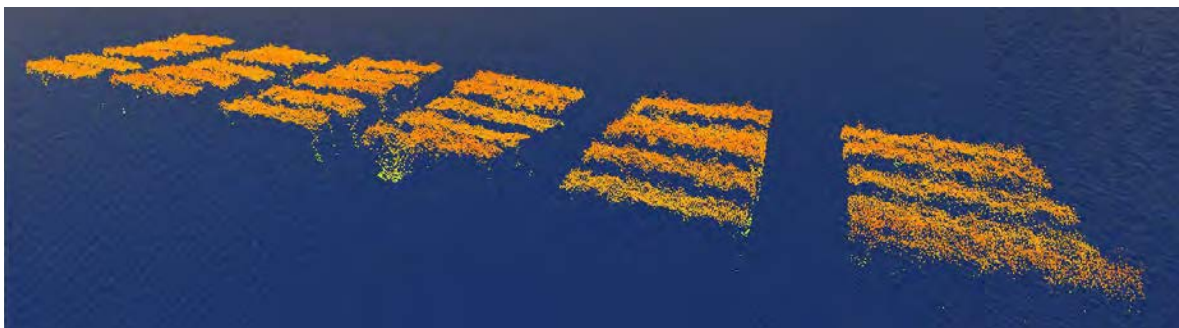
Figura 4. Nube de puntos proveniente del sensor LiDAR LiAir V70 (a), y nube de puntos densa surgida del geoprocesamiento fotogramétrico de las imágenes RGB captadas por la cámara Sony 5100 (b).
