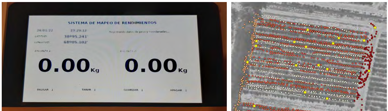
Figura 2. Monitor de rendimiento donde se visualiza toda la información referida a los datos que se registran durante la cosecha como el peso, las coordenadas y el estado del sistema (izquierda), y mapa de rendimiento con identificación, en el posprocesamiento, de segmentos de trayectoria y localización de los bins llenos representados con cuadrados amarillos (derecha).
