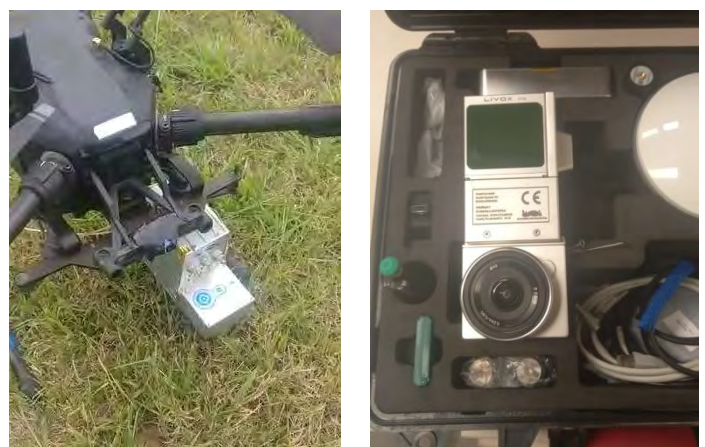
Figura 2. Disposición del sensor integrado LiAir V70 en la parte ventral del UAV DJI Matrice 210 (izq.). Detalle de la cámara Sony 5100 integrada en la carcasa del sensor (der.).
