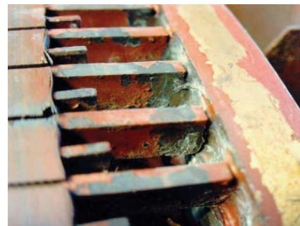
Broken rotor bar
