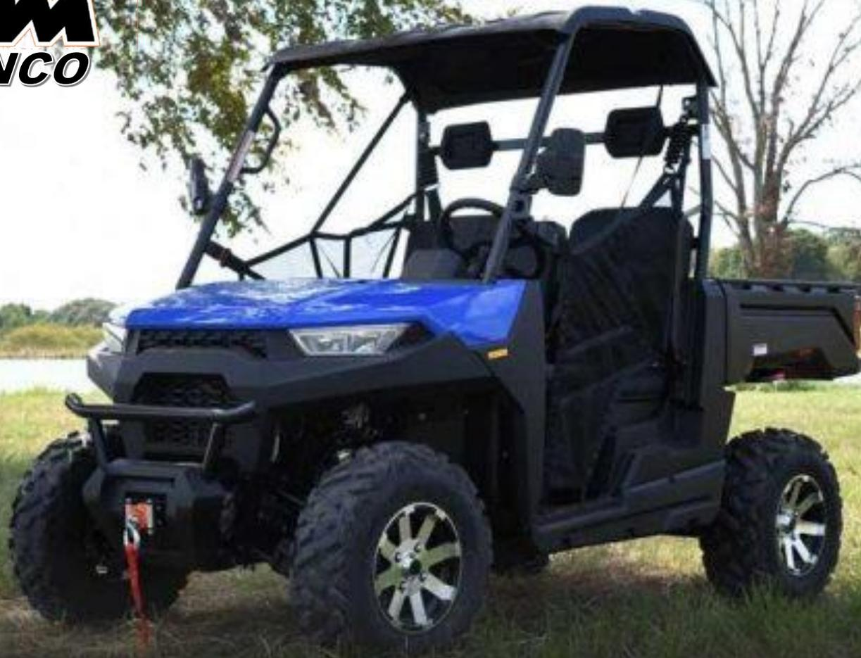
Especialmente diseñado para el trabajo y altas exigencias, cuenta con 4x4, bloqueo de diferencial y DUAL, además de una caja de transmisión independiente, que le otorga fiabilidad y gran capacidad.
