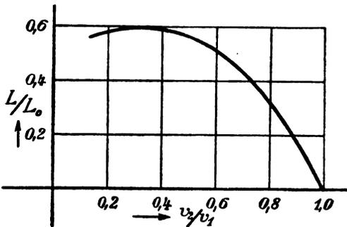
Abb. 9. Abhängigkeit der theoretischen Windradleistung von der Stärke der Abbremsung des Windes.
