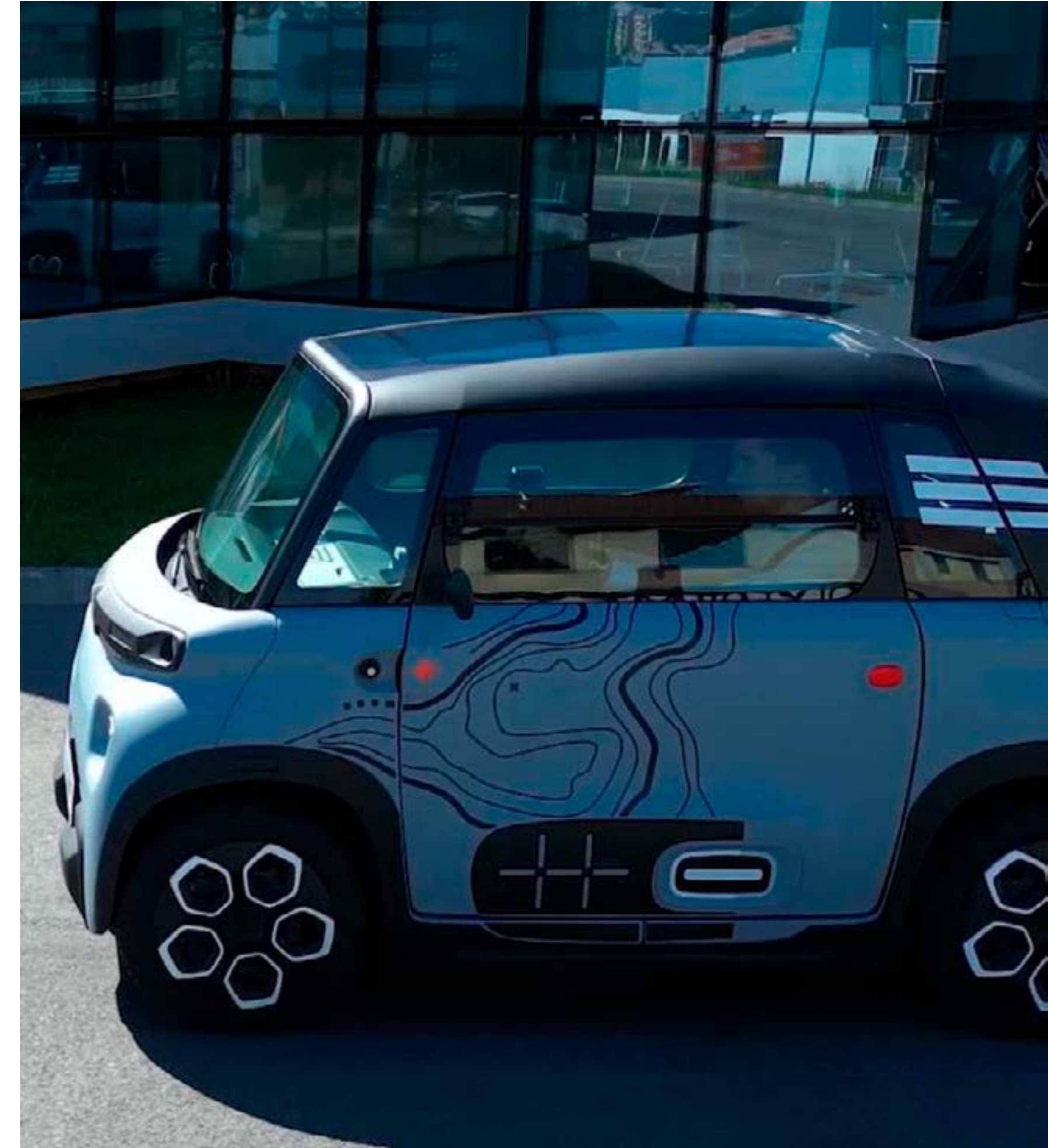
Valoe valmisti yhdessä Simoldes Plasticosin kanssa kevyen polymeeripohjaisen aurinkosähkökaton prototyyppejä Stellantikselle. Valoen komposiittirakenteinen solar-katto lujittaa ko. auton rakennetta, on kevyt ja mekaanisesti kestävä - kestää myös jatkuvan harjapesun.
