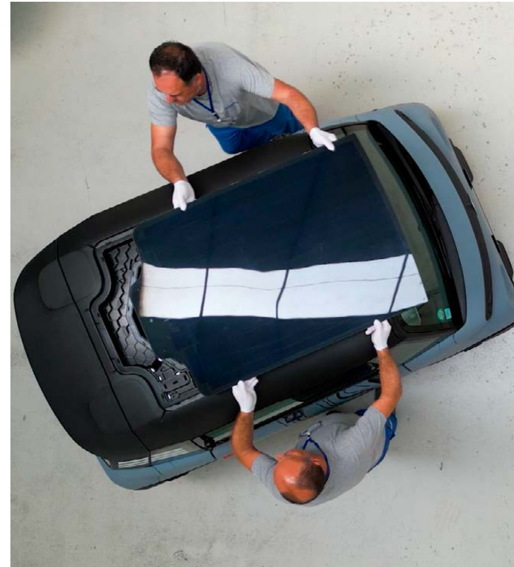
Simoldes Plasticos ja Valoe kehittivät yhdessä komposiiteista valmistetun aurinkokattomodulin. Kuvasta voi havaita modulin keveyden. Myös asennus näyttää helpolta.
