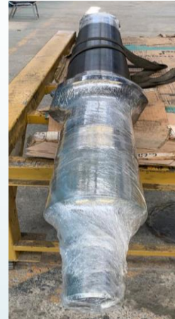
Reconstrucción de Cañón Y Husillo
