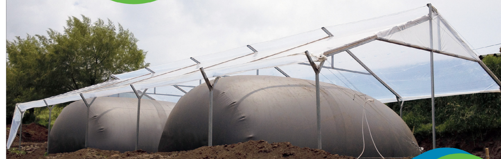
Planta de biogás en Asia del Este Sustrato: Desechos alimenticios, pasto, cereales, residuos de separadores de grasa. Capacidad eléctrica: 370 kW
