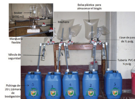
Figura 1. Biodigestores de flujo discontinuo tipo "batch" usados en el experimento. Se puede apreciar la bolsa-reservorio para medir la producción de biogás. Fuente: elaboración propia a partir de archivo personal.
