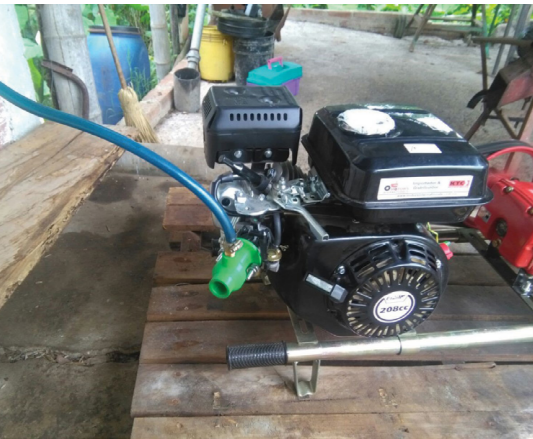
Boquilla tipo Venturi para la adaptación del biogás al motor.
