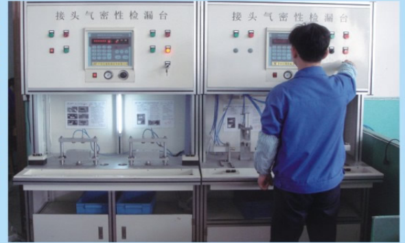
接头气密性检测 Non-Leak Testing
