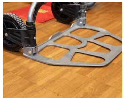
- KIPPELT: Einige Modelle stehen nicht flächig auf – hier zu sehen bei Stier .
