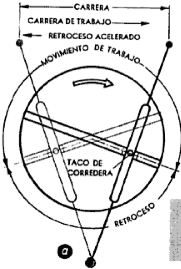
Fig. 40,2 Mecanismo de biela y corredera para el accionamiento de una máquina horizontal de mortajar (limadora): a) corredera grande; b) corredera pequeña
