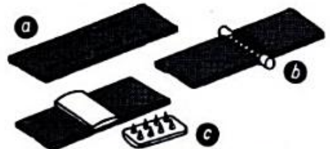
Fig. 26,2 Uniones de correas: a) pegado, cosido; b) grapas de alambre con tiras de cuero de cerdo; c) unión de fundición maleable con puntas fundidas de una pieza
