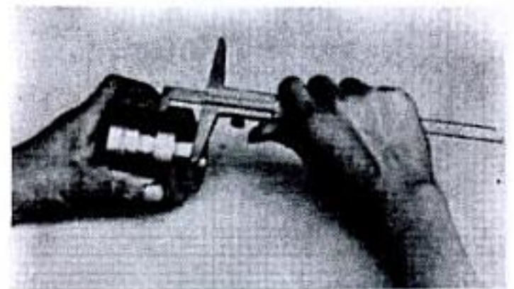
Fig. 70,4 Medición por medio de un calibre de profundidades con lengüeta angular
