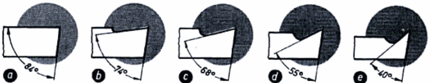
Fig. 14,2 Relación entre el ángulo de ataque y el material de la pieza: a) fundición dura, piezas duras de latón y de bronce; b) acero y acero moldeado de gran resistencia, fundición gris dura, latón, bronce; c) acero (acero moldeado) de resistencia media, fundición gris normal; d) tipos blandos de bronce; e) metales ligeros
