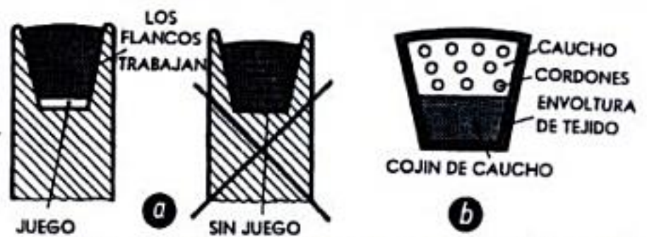
Fig. 26,4 Correas trapeciales: a) la correa trapecial no debe llegar al fondo de la ranura; b) sección de una correa trapecial.
