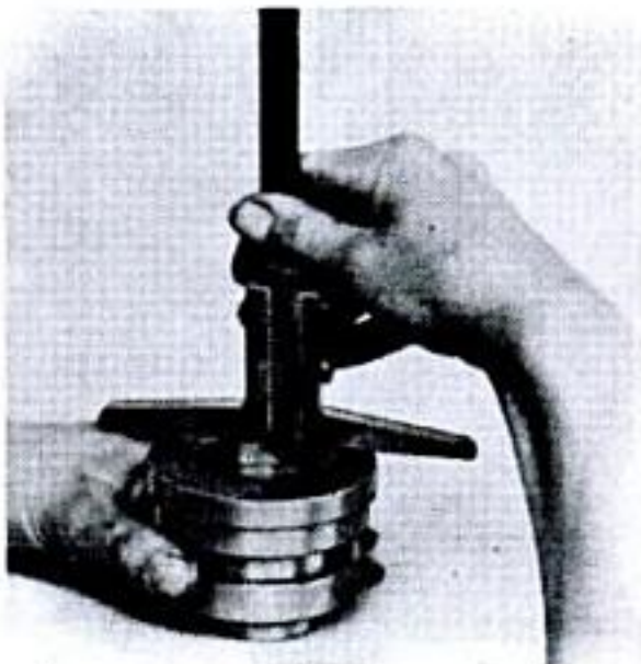
Fig. 70,3 Medición con el calibre de profundidades
