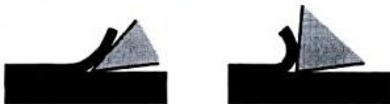
Fig. 13,3 Ángulo de ataque grande = ángulo de filo pequeño. Cuanto menor es el ángulo de ataque tanto más fuertemente curvada y aplastada resulta la viruta
