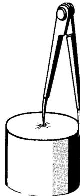
**Figura 1.130** Trazado del centro por medio del compás hermafrodita.
