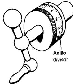
**Figura 1.99** Mediante giro de una división en el anillo divisor, el útil de torno avanza generalmente 0,05 mm. Cuando por equivocación se ha girado demasiado, gírese la manivela al revés (marcha muerta) y vuélvase a ajustar.
