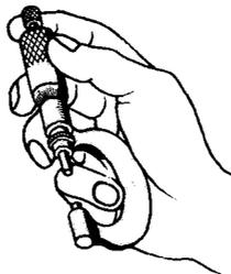
Figura 1.114 Utilización del p almer con una sola mano.
