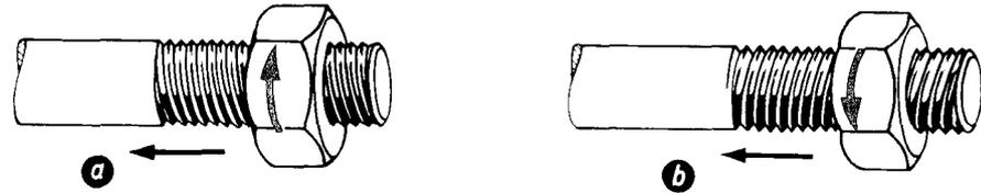
**Figura 9.5** Sentido del paso de la rosca. a) Rosca de paso a la derecha; b) rosca de paso a la izquierda.
