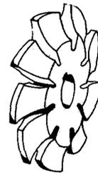
Figura 10.11 Fresa para tallar engranajes.
