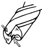
Figura 2.24 Acortamiento del filo transversal mediante afilado.
