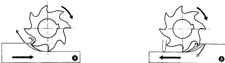
**Figura 4.5** Movimiento de avance en el fresado cilíndrico. a) Fresado de contramarcha; b) fresado en favor del avance.
