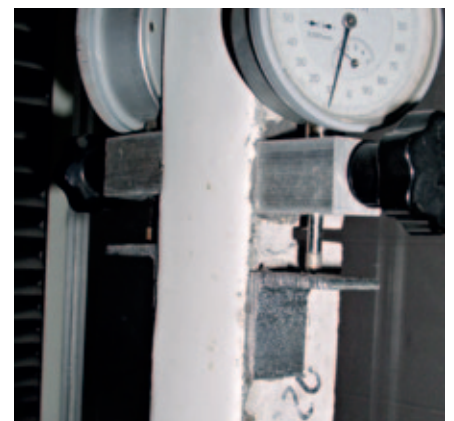
Ensayo puenteo de fisuras dinámicas según EN 10627 (Método B)
