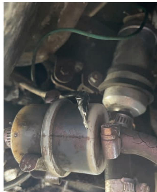
Igensatt bränslefilter – inte att rekommendera. Så här ska det se ut: ny pump, filter, slangar och klämmor (t.h.).
