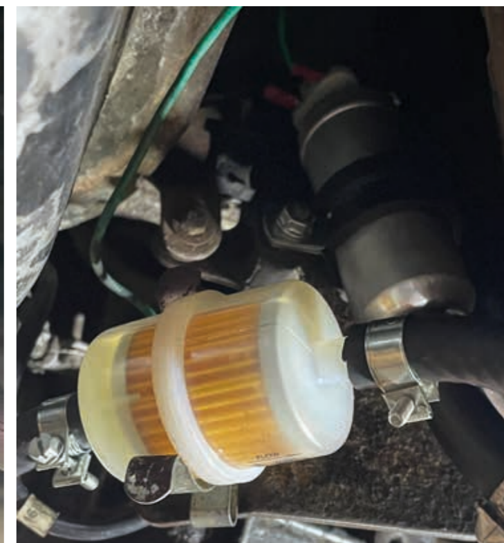
Igensatt bränslefilter – inte att rekommendera. Så här ska det se ut: ny pump, filter, slangar och klämmor (t.h.).
