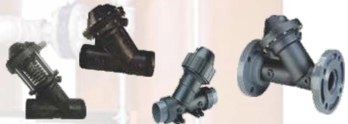
Válvulas de diafragma en cuerpo de Noril reforzado con fibra de vidrio de 1/2" a 3", con conexiones roscada, cementable y bridada.
