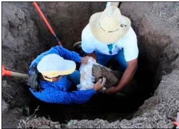
Figura 23. Extracción del monolito.
