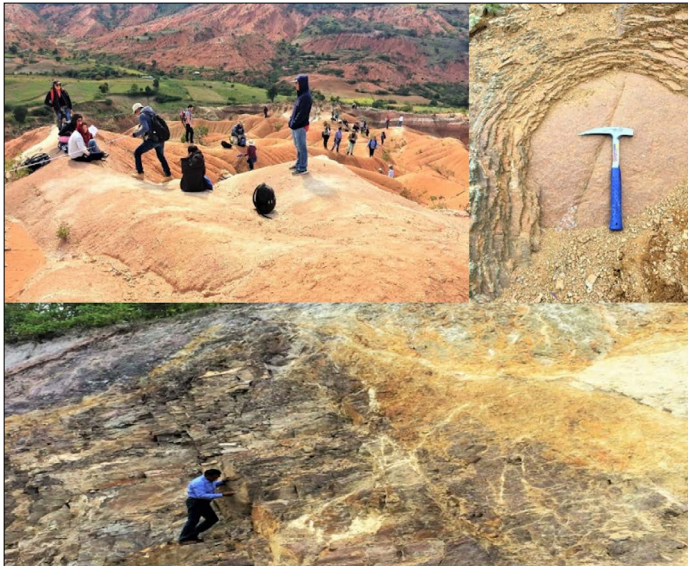
Figura 3. Midiendo el largo de un afloramiento con wincha y GPS para ubicación geográfica (superior izquierda), el tamaño del intemperismo esferoidal con una pica (superior derecha) o el alto de un afloramiento con la altura de una persona (mide 1.80 metros, inferior).
