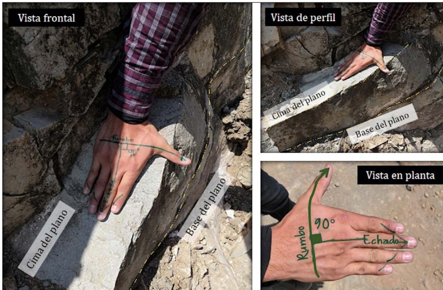
Figura 3. Homologación de la mano derecha con el plano que se desea medir (en este caso es un estrato), mediante el método de la RMD. La orientación en la que se encuentra el dedo pulgar es la misma en la que se debe colocar la pínula mayor, para tomar el dato del rumbo con la brújula tipo Brunton. Fuente: elaboración propia.
