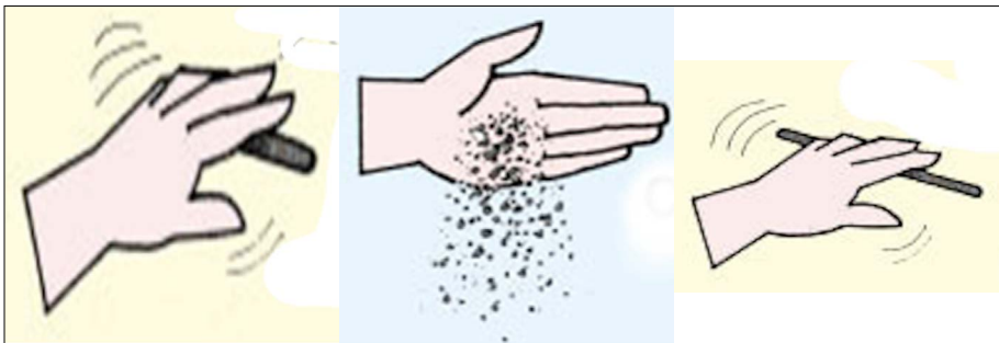
Figura 2. Ilustración de algunos de los pasos para la determinación de la textura "al tacto". Fuente: ilustraciones tomadas de Coche (1986).
