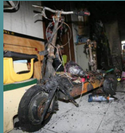
INCENDIO DE UNA PATINETA ELÉCTRICA MIENTRAS SE RECARGABA DENTRO DE UN APARTAMENTO
