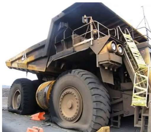
Vehículo minero luego de un incendio. Fuente: Curso sobre minería del Fire Protection Institute.
