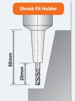
• Logra gran potencia de torsión mediante la integración del portaherramientas y la herramienta
