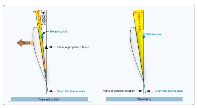
Figure 11-7. Propeller blade angle.
