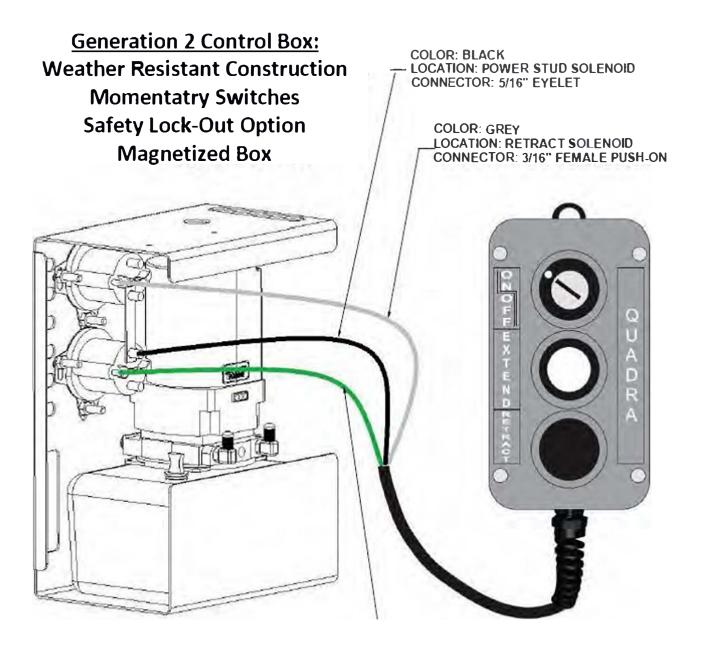
COLOR: GREEN LOCATION: EXTEND SOLENOID CONNECTOR: 3/16" FEMALE PUSH-ON
