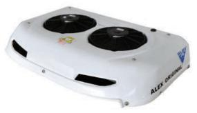
TRCR-321, 12V, +0°C, R134a, (For Evaporator TRE 321) TRCR-341, 24V, +0°C, R134a, (For Evaporator TRE 341) TRCR-324, 12V, -20°C, 404A, (For Evaporator TRE 324) TRCR-344, 24V, -20°C, 404A, (For Evaporator TRE 344)
