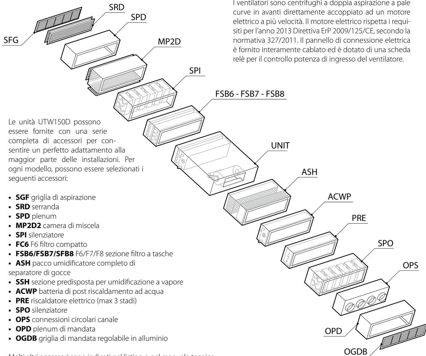
Le unità UTW150D possono essere fornite con una serie completa di accessori per consentire un perfetto adattamento alla maggior parte delle installazioni. Per ogni modello, possono essere selezionati i seguenti accessori:
