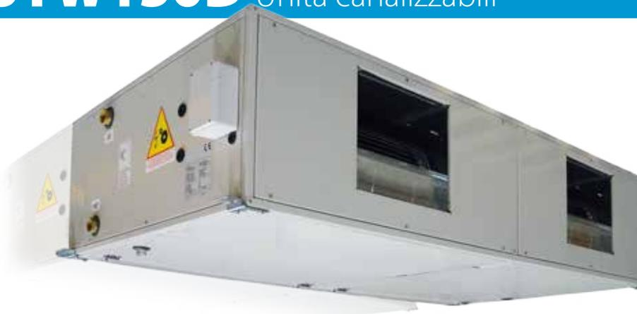
Il telaio è realizzato con profili in acciaio e pannelli sono di tipo sandwich con isolamento termico e acustico in lana minerale (spessore 10 mm per i modelli dal 10 a 42, spessore di 20 mm per modelli 51 e 65). I pannelli sono in acciaio preverniciato esterno, acciaio zincato galvanizzato all'interno, completo di guarnizioni, fissati al telaio mediante viti in acciaio
