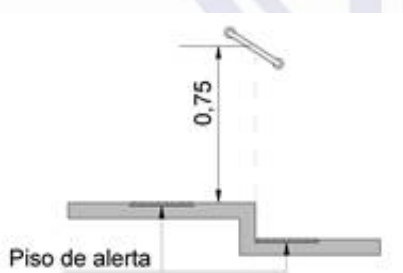
a) Barra de apoio inclinada
