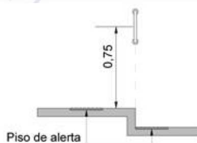
b) Barra de apoio vertical
