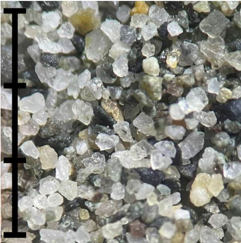
Imagen de la muestra C07 bajo el microscopio binocular. Escala: tres milímetros.
