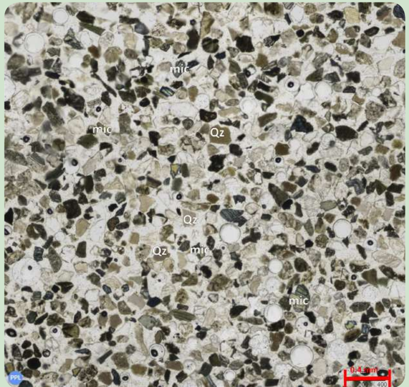
Fotografía de sección delgada tomada con microscopio petrográfico de luz transmitida con nicols cruzados (arriba) y paralelos (abajo) de la muestra C02. Escala 400 µm.
