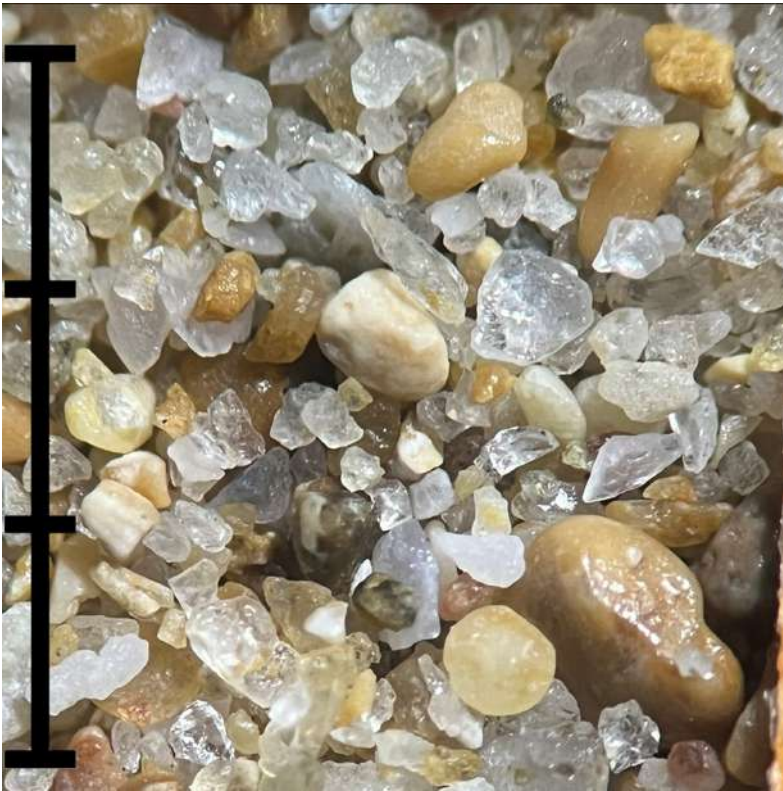
Imagen de la muestra C21 bajo el microscopio binocular. Escala: tres milímetros.
