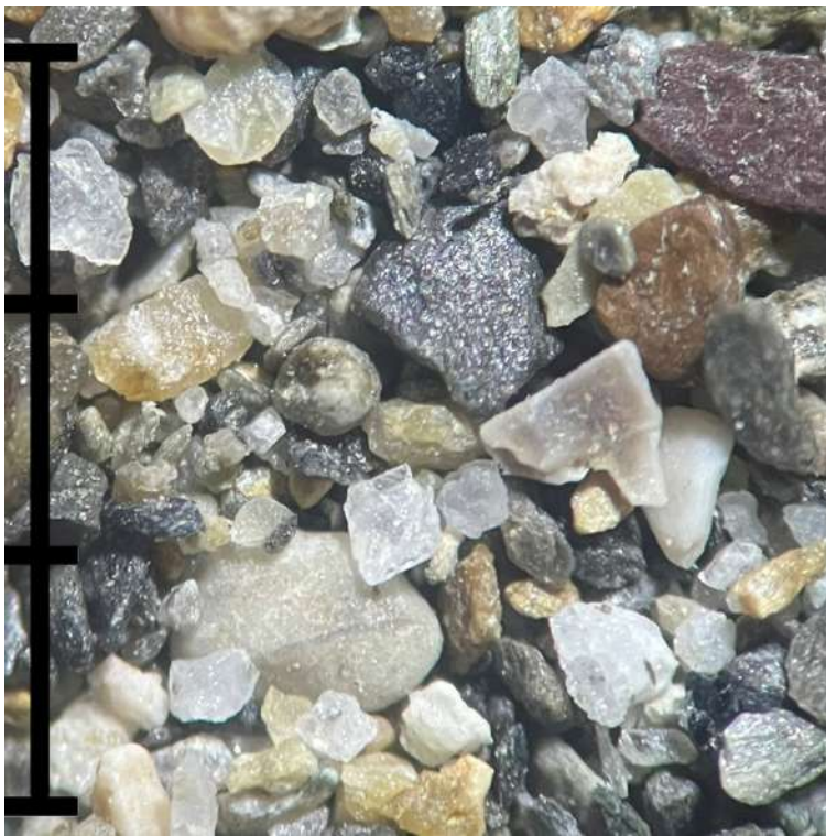
Imagen de la muestra P06 bajo el microscopio binocular. Escala: tres milímetros.
