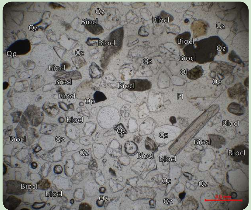
Fotografía de sección delgada tomada con microscópio petrográfico de luz transmitida con nicols cruzados (arriba) y paralelos (abajo) de la muestra C18. Escala 500 µm.
