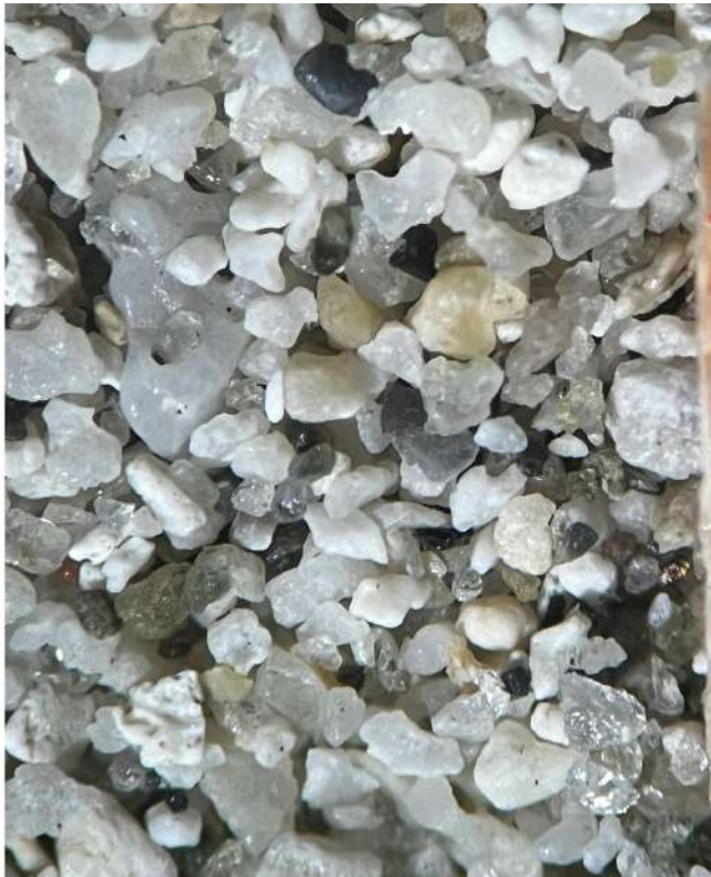
Imagen de la muestra C09 bajo el microscopio binocular. Escala: tres milímetros.
