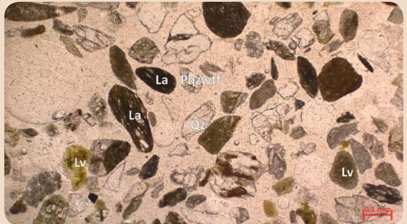
Fotografía de sección delgada tomada con microscopio petrográfico de luz transmitida con nicols cruzados (arriba) y paralelos (abajo) de la muestra P06. Escala 100 \mu m.
