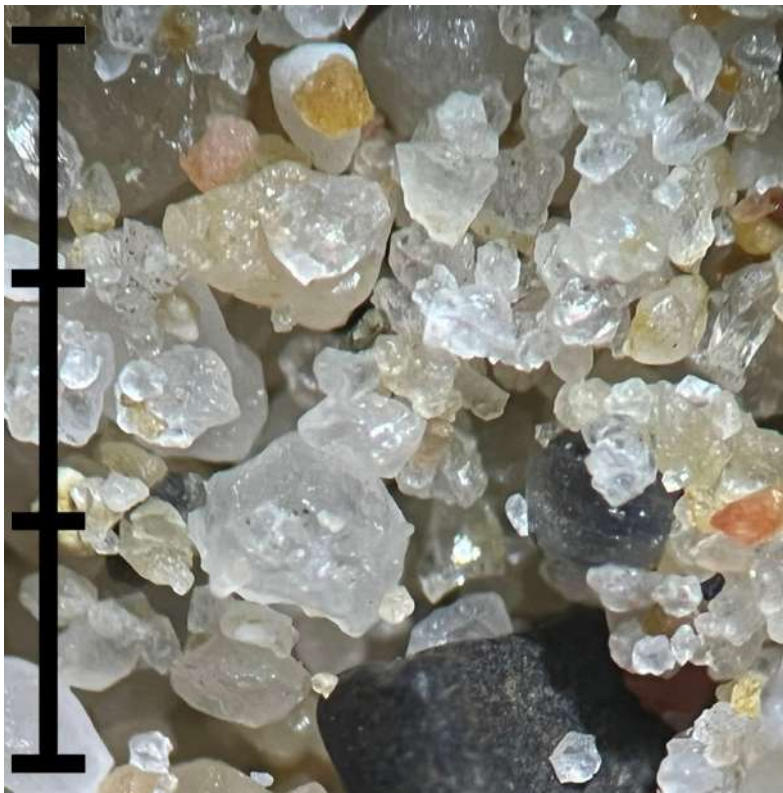
Imagen de la muestra C08 bajo el microscopio binocular. Escala: tres milímetros.
