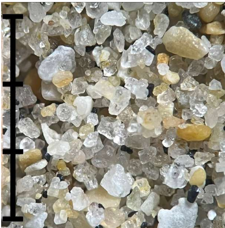
Imagen de la muestra C18 bajo el microscopio binocular. Escala: tres milímetros.
