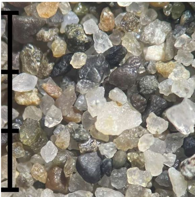
Imagen de la muestra P08 bajo el microscopio binocular. Escala: tres milímetros.
