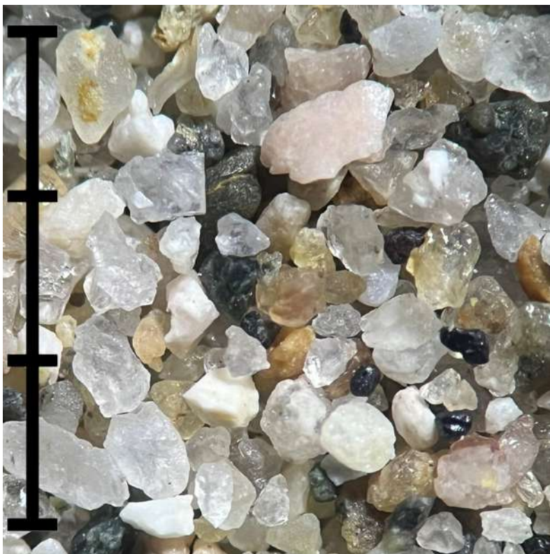
Imagen de la muestra C16 bajo el microscopio binocular. Escala: tres milímetros.
