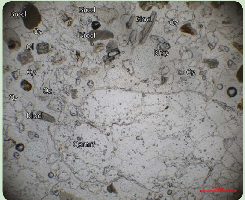
Fotografía de sección delgada tomada con microscópio petrográfico de luz transmitida con nicoles cruzados (arriba) y paralelos (abajo) de la muestra C20. Escala 500 µm.
