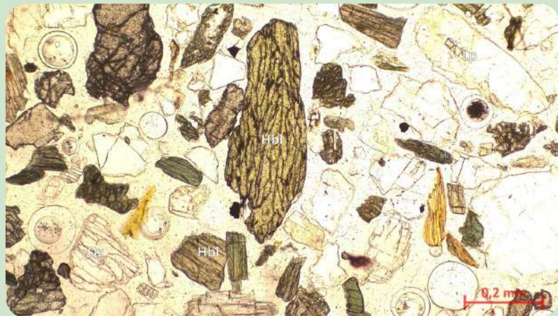
Fotografía de sección delgada tomada con microscopio petrográfico de luz transmitida con nicols cruzados (arriba) y paralelos (abajo) de la muestra C13. Escala 200 \mu\text{m} .
