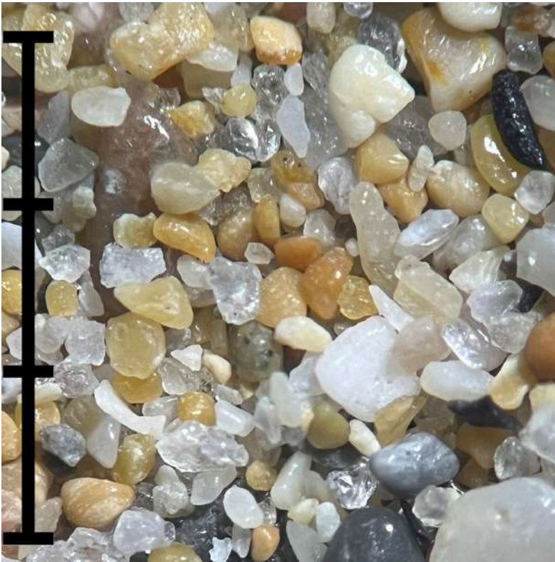
Imagen de la muestra C19 bajo el microscopio binocular. Escala: tres milímetros.
