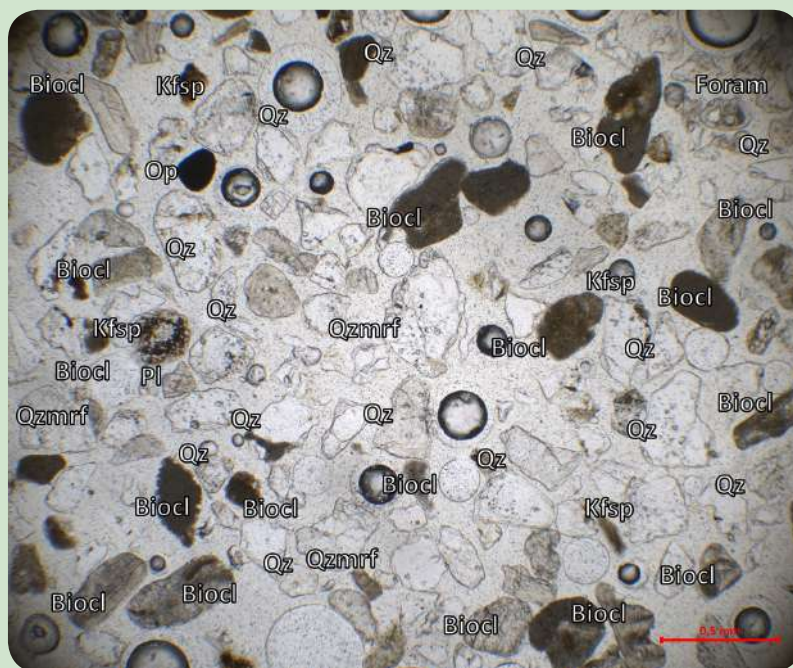
Fotografía de sección delgada tomada con microscopio petrográfico de luz transmitida con nicols cruzados (arriba) y paralelos (abajo) de la muestra C21. Escala 500 \mu m.
