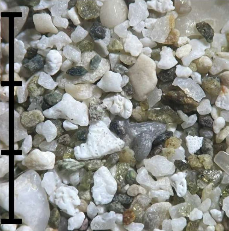
Imagen de la muestra C01 bajo el microscopio binocular. Escala: tres milímetros.
