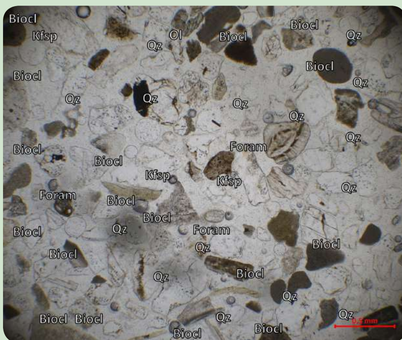
Fotografía de sección delgada tomada con microscopio petrográfico de luz transmitida con nicols cruzados (arriba) y paralelos (abajo) de la muestra C17. Escala 500 µm.
