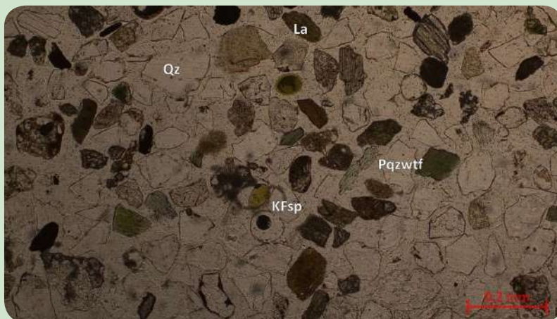
Fotografía de sección delgada tomada con microscopio petrográfico de luz transmitida con nicols cruzados (arriba) y paralelos (abajo) de la muestra C11. Escala 200 \mu m.
