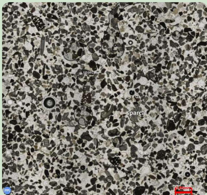
Fotografía de sección delgada tomada con microscopio petrográfico de luz transmitida con nicoles cruzados (arriba) y paralelos (abajo) de la muestra C09. Escala 500 \mu\text{m} .
