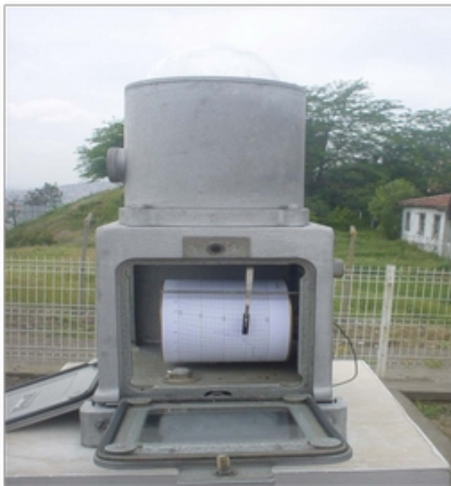
Figura 23. Actinógrafo para medida da radiação solar global horizontal. Visualiza-se a caneta registradora e o papel milimetrado para impressão do valor instantâneo da radiação solar incidente. Fonte: Adaptado de WMO.
