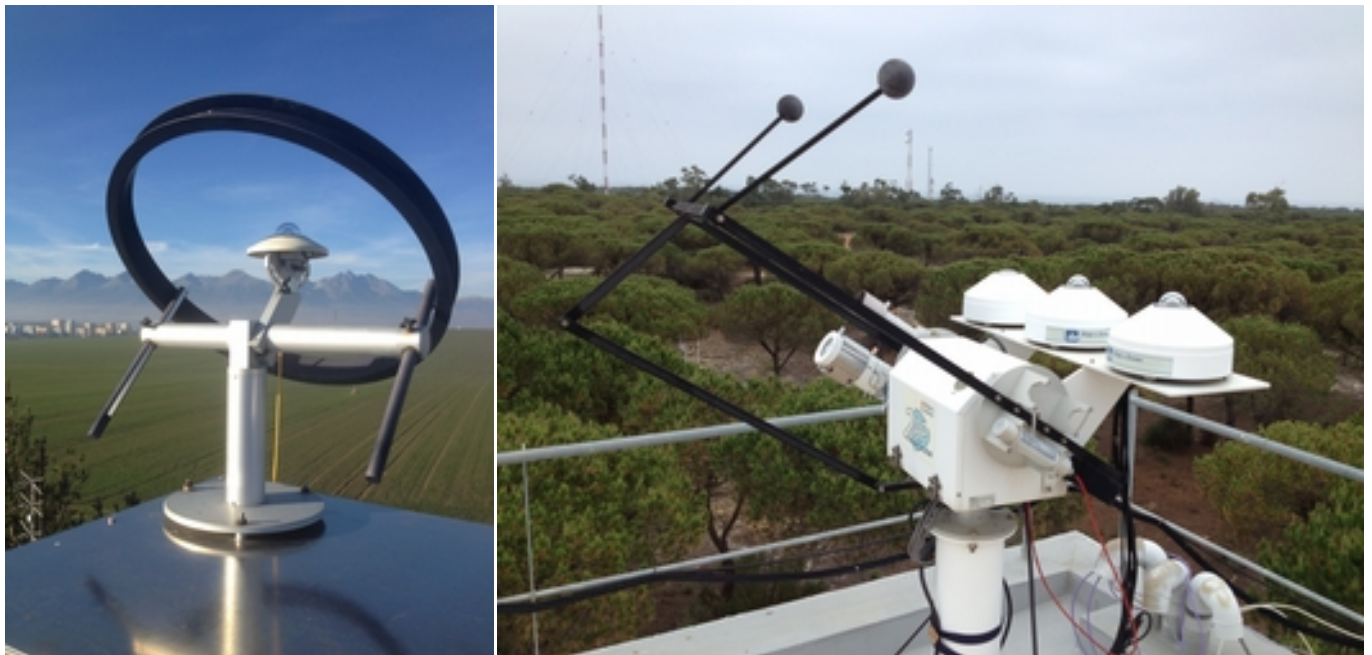
Figura 24. Instrumentos utilizados para medida da componente difusa da radiação solar. À esquerda montagem de sistema com piranômetro e anel de sombra. À direita piranômetros, pireliômetro e sistema de rastreamento com esferas para bloqueio do disco solar. Fonte: Adaptado de Kipp & Zonen.
