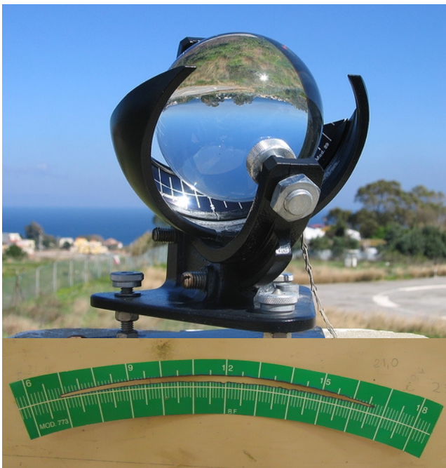
Figura 22. Heliógrafo para medida da insolação e fita de medição de horas de sol pleno durante um dia de céu limpo. Fonte: Adaptado de Wikipedia e IAG-USP.
