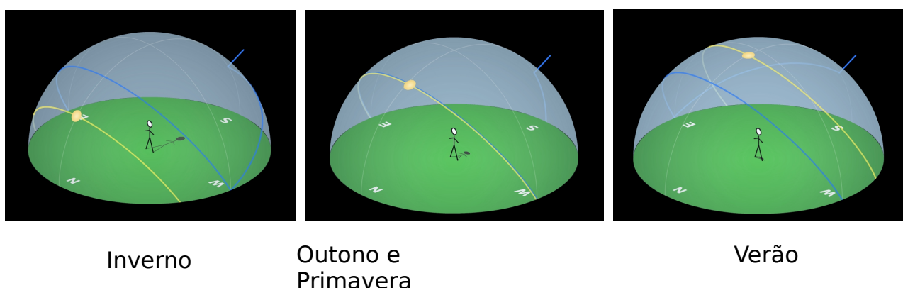
Figura 13. Variação do posicionamento do Sol para na esfera celeste ao longo do ano para a latitude - 30 graus.. Temos a posição do Sol no meio dia solar no primeiro dia de inverno (21 de junho), outono e primavera (21 de março e 22 de setembro, respectivamente) e verão (21 de dezembro).
