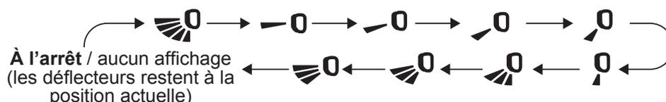
Lorsque vous sélectionnez le réglage "☼" les déflecteurs d'air se balancent continuellement de haut en bas à l'angle maximum.
