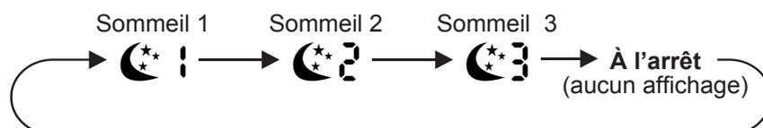
**Sommeil 1 :** En mode *Refroidissement*, une heure après le réglage du mode, la température augmente de 1 °C. Après deux heures, la température augmente de nouveau de 2 °C. L'appareil maintient ensuite cette température.
