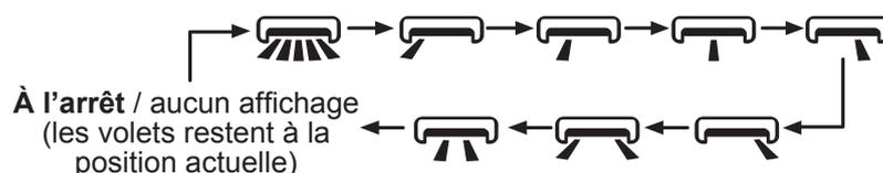
Lorsque le paramètre passe de "OFF" (à l'arrêt) à "☰", si vous retardez l'appui du bouton de plus de 2 secondes, le paramètre retournera directement à l'état "OFF".
