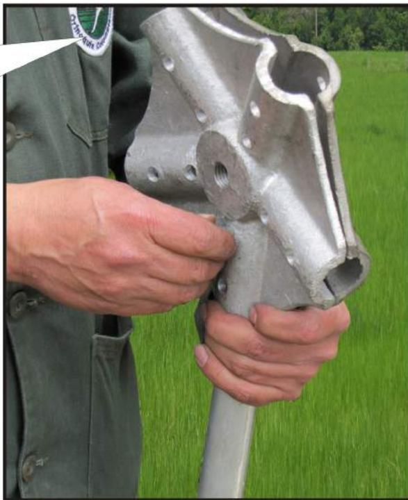
Se aprietan los 10 tornillos (largos) alternando un lado con otro, varias veces hasta que todos se sientan bien ajustados. Esto puede durar hasta 20 minutos.
