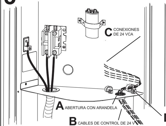
— CABLEADO DE ALTO VOLTAJE EN EL SITIO
