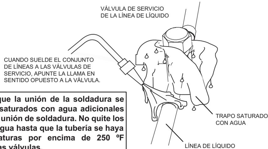
**IMPORTANTE** – Deje que la unión de la soldadura se enfríe. Aplique trapos saturados con agua adicionales para ayudar a enfriar la unión de soldadura. No quite los trapos saturados con agua hasta que la tubería se haya enfriado. Las temperaturas por encima de 250 °F dañarán los sellos de las válvulas.
