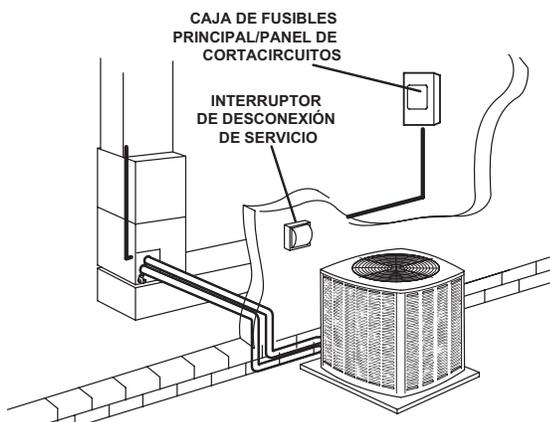
**NOTA** - Las unidades se aprueban para usarse con conductores de cobre únicamente. Conecte a tierra la unidad en el interruptor de desconexión o conéctela a una tierra sólida.
