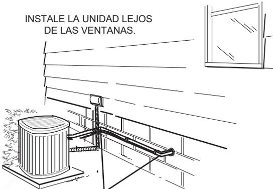
DOS CODOS DE 90° INSTALADOS EN EL CONJUNTO DE LÍNEAS REDUCIRÁN LA VIBRACIÓN DEL CONJUNTO.
