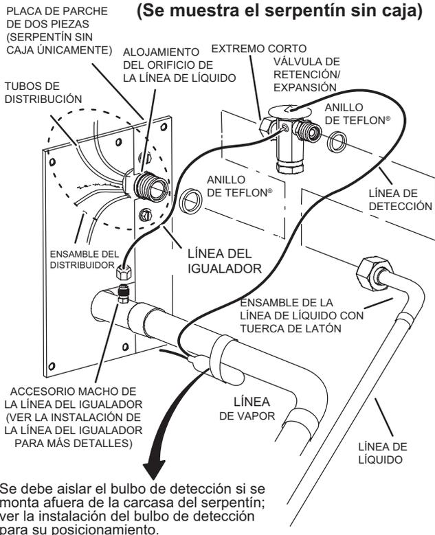
Se debe aislar el bulbo de detección si se monta afuera de la carcasa del serpentín; ver la instalación del bulbo de detección para su posicionamiento.
