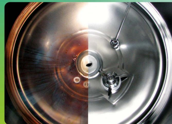
Derouging bezeichnet den chemischen Prozess zur Entfernung von Rouge, einem Korrosionsrückstand auf Edelstahloberflächen.
