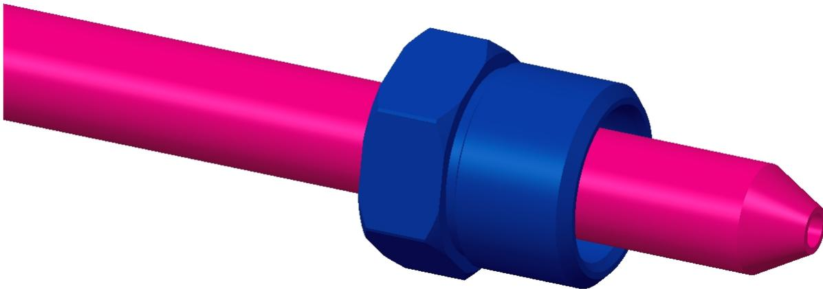
2. Den Druckring auf die Lanze schrauben (Linksgewinde). Der Druckring mit der ganzen Gewindefläche auf die Lanze schrauben.
