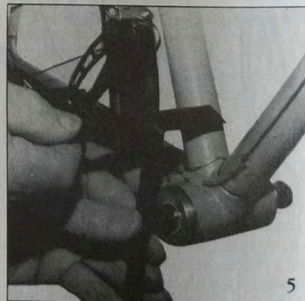
photo 1 : Léger meulage de l'intérieur de la boîte de pédalier du cadre.
