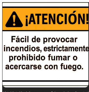
Fig. 1-6 Colocar junto a la boca de llenado del depósito de combustible Requisitos de uso del depósito de combustible
