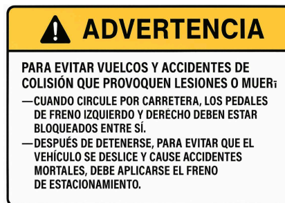
Figura 1-4 Pegado en el guardabarros trasero derecho Requisitos para el uso del freno del tractor
