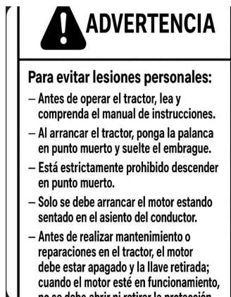
Figura 1-3 Pegada en el tablero de instrumentos Requisitos para el uso y operación del tractor
