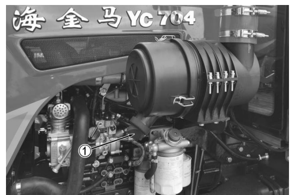
(1) Válvula de purga de aire
