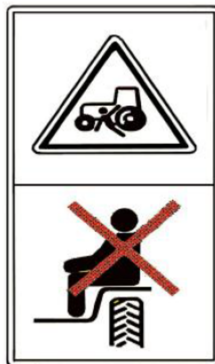
Figura. 1-2 se adjunta a la placa de protección de la rueda trasera izquierda Indica la prohibición de los pasajeros en los no ocupantes
