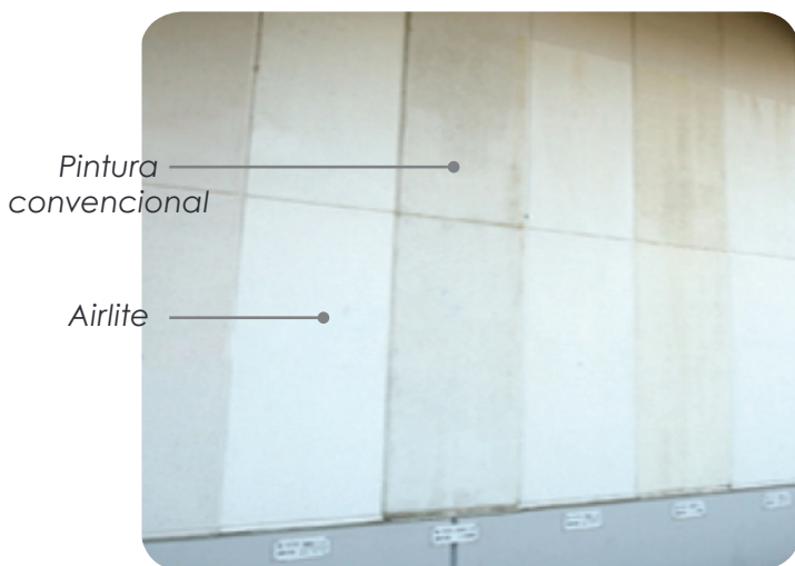
Diferencia entre Airlite y una pintura convencional después de 9 meses de prueba
