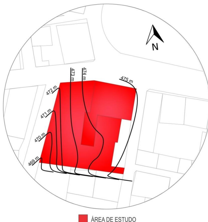
Figura 25 – Implantação do terreno com curvas de nível
