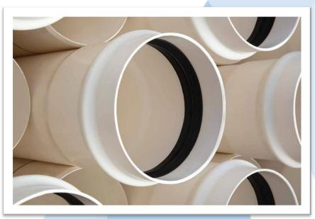
La tubería PVC hidráulica serie inglesa se conserva lisa en su interior tras años de servicio, por lo que no pierde capacidad de conducción. La unión con anillo Rieber de la tubería permite un rápido ensamble y unión hermética, lo cual la protege de vibraciones, movimientos de tierra y compensaciones por dilatación y contracción, además de que no se desprenderá durante el ensamble
